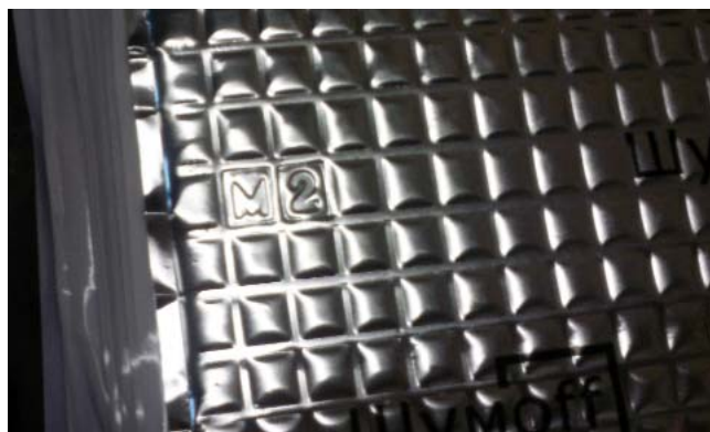
Материалы Шумофф отличает оригинальная выштамповка, которая остается после прокатки валиком.
